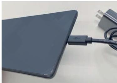
側面にある充電口に専用お知らせ機器用充電器を繋いで充電してください。充電中はLEDが赤色に点灯します。充電が完了するとLEDランプが緑色に点灯します。
