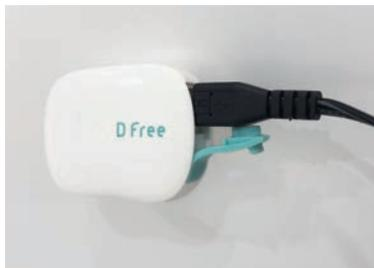
充電端子カバーを外し、DFree用充電器を奥まで挿して充電してください。充電中はLEDランプが赤色に点灯します。充電が完了するとLEDランプが緑色に点灯します。
